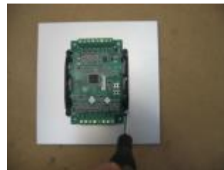
APPLICARE LE VITI PER IL FISSAGGIO AL TELAIO
