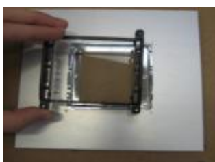
SPOSTARE IL TELAIO IN ALTO IN MODO TALE CHE I RILIEVI DELLA CORNICE NON RIMANGANO INCASTRATI CON LE FESSURE DEL TELAIO
